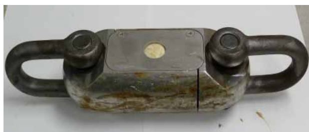
両端を引く力を測る牽引力記録計 頑丈、コンパクトで扱いやすい（4kg）
