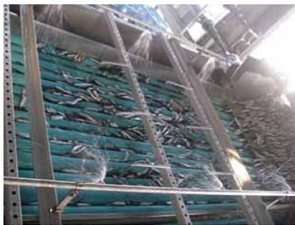
大型選別機を導入し、水揚げ時間を短縮。鮮度保持にも貢献。
