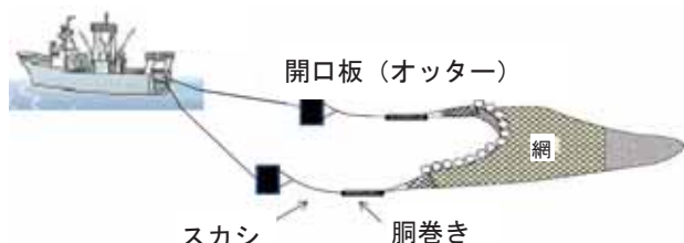
大昭丸の漁具構造の模式図。胴巻きを大幅削減し、漁具を軽量化、燃費が向上した。
