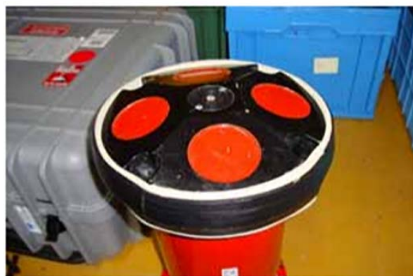
図2 計測に実施した可搬型の超音波流向流速計。空中重量13.0kg、水中重量4.5kg。網口上部に超音波が下向きに発射されるように装着し、曳網中の網の対地速度を計測する。
